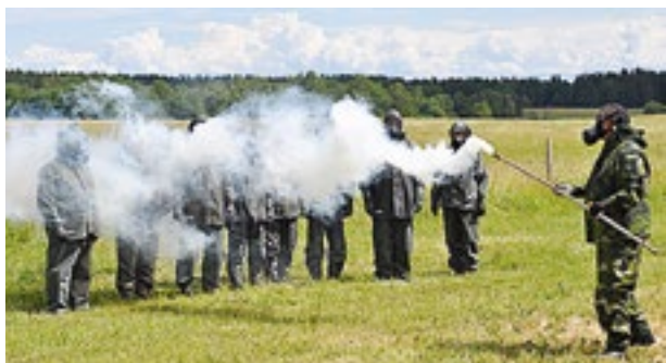
Täthetsprov av skyddsmask med tårgasfackla. Foto: Jörgen Öberg
