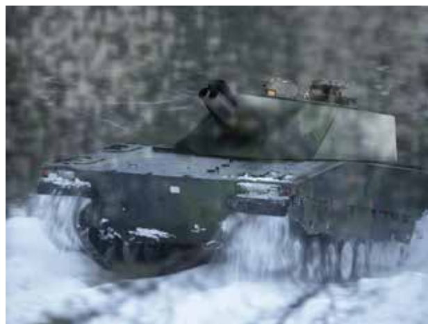
Det blev Hägglunds och BAE Systems Bofors som vann upphandlingen av nytt bataljonsartilleri i form av en granatkastarvagn med två eldrör på ett stridsfordon 90-chassi. Illustration: HB Utveckling
