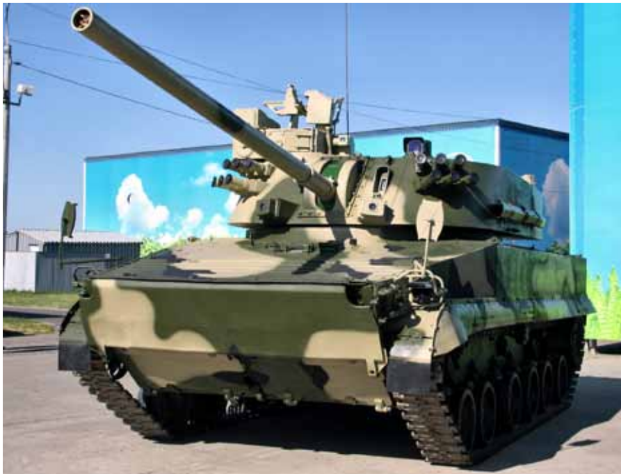
Bandkanon modell 2S31 med en 120 millimeters pjäs som både kan fungera som granatkastare och vanlig artilleripjäs. Tillförs marininfanteriet under nästa år.
