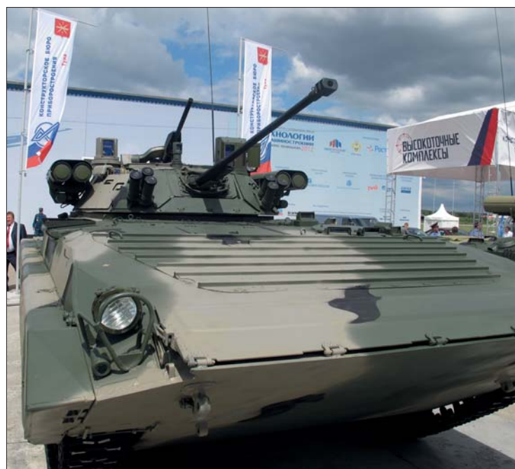
BMP-2M är ett tydligt exempel där Ryssland renoverar och uppgraderar befintlig materiel. Detta pansarskyttefordon introducerades under 1980-talet. Med extra pansarskydd och nya pansarvärnsrobotar har stridsvikten ökat till 16 ton.
