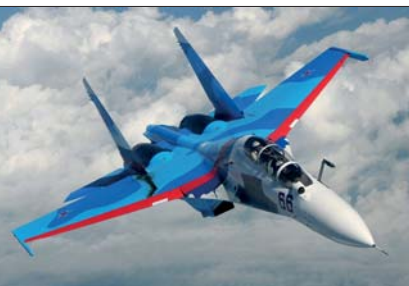
Su-30 SM är en vidareutveckling av det ryska jaktplanet Suchoi Su-27. Flygplanet är ett multirollflygplan med allväderskapacitet. Planets goda prestanda har gjort det till en rysk exportsuccé. Ett ryskt flygförband utrustas för närvarande med dessa flygplan i Kaliningradområdet.
