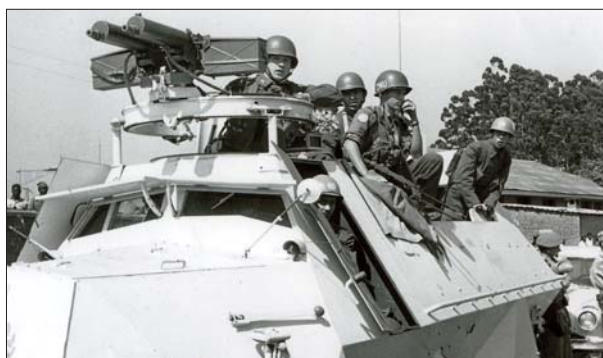
Ksp m/36 i dubbelt LV-montage på KP-bil, Kongo 1961. Notera ångslangarna under manteln på vapnen.
