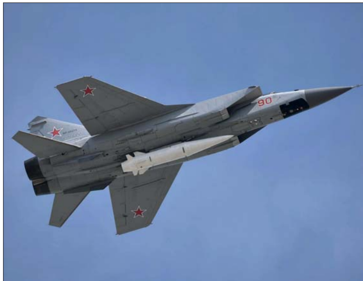
I mars 2018 provsköts en hypersonisk robot av typ Kinzhal. Det var en MiG-31 (bilden) som var vapenbärare. Med en hastighet av 10 Mach (10 000-12 000 km/h) har roboten en räckvidd av 2 000 km. Roboten kan förses med en kärnstrids-spets och är en allvarlig utmaning för USA och NATO.
