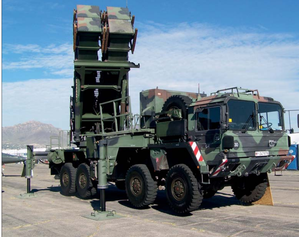
Det välkända luftvärnsrobotsystemet Patriot används av 15 länder och systemet har varit operativt sedan 35 år tillbaka. Tysklands version på bild är av den senaste versionen. De äldre versionerna har avvecklats. Sverige överväger att inköpa den senaste versionen som kan bekämpa kryssningsrobotar och ballistiska robotar. Maximal höjdtäckning är 24 000 meter.
