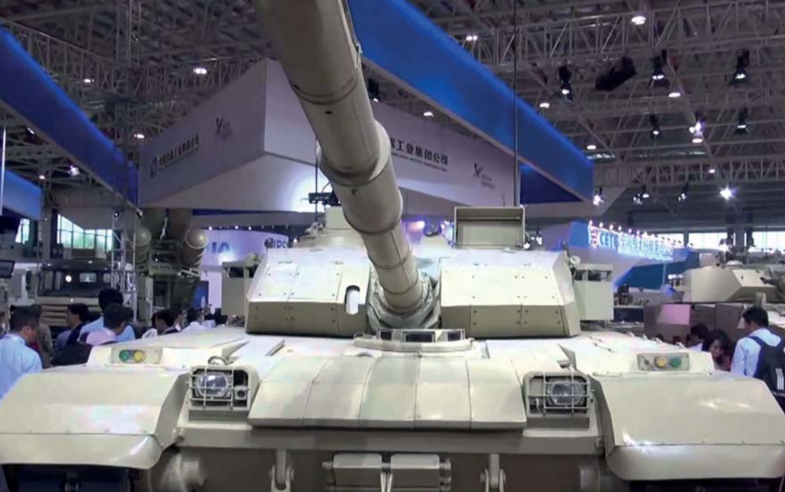
Här visar Kina sin senaste nyutvecklade stridsvagn VT-4 på en vapenmässa. Stridsvagnen väger 52 ton och har en kinesiskutvecklad dieselmotor på 1 300 hästkrafter. Annars är det mycket som kommer från den ryska stridsvagnsteknologin inklusive den automatladdade kanonen med 12,5 cm kaliber.
