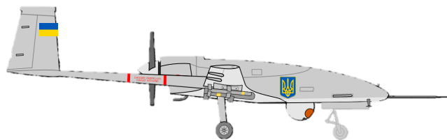
Bayraktar TB2 är en turkisk drönare (UAV) som är avsedd för spaning och kan beväpnas med en kanon eller två pansarvärnsrobotar. Under kriget mellan Ryssland och Ukraina har Ukraina använt Bayraktar TB2 mot ryska stridsvagnar, pansarfordon och örlogsfartyg.
