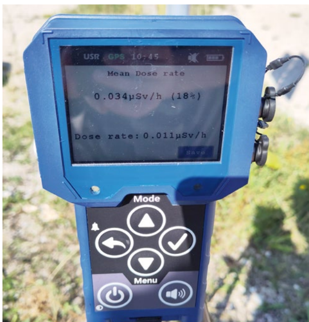
Doshastighetsmätaren Saphyrad kan användas vid situationer där man behöver mäta joniserande strålning, till exempel en kärnkraftsolycka. Foto: Anna Norberg
